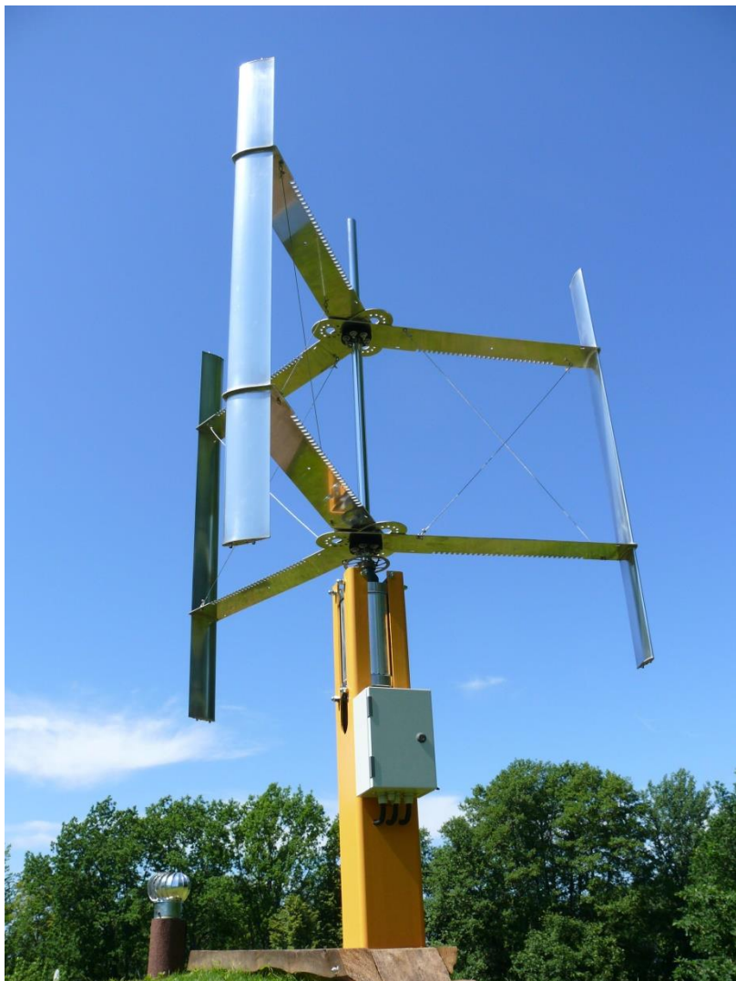
Joonis 8 Väljavõte TT 2013.a. taotlusest, alumiiniumist labadega vertikaaltuuliku katseeksemplar
